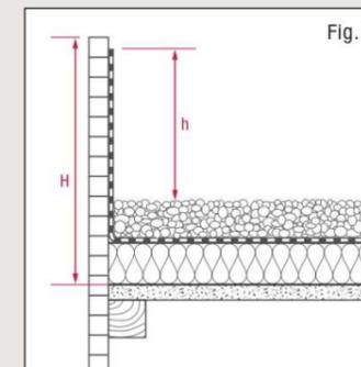
**Élément porteur de partie courante en maçonnerie (DTU 43.1/NF P 84.204)**
