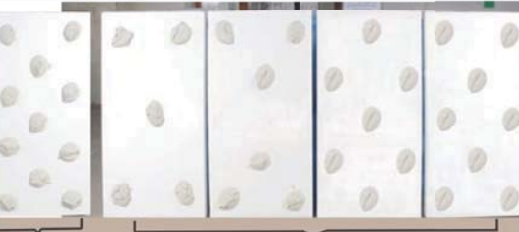
4. Pose collée 5. Pose calée / chevillée 11 plots (16/m 2 ) 5 plots (6,9/m 2 ) 6 plots (8,3/m 2 ) 7 plots (9,7/m 2 ) 8 plots (11,1/m 2 )
